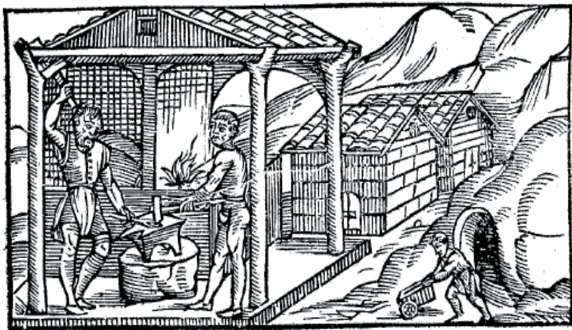
Fig. 3 – Il complesso delle operazioni minerarie rappresentato in modo integrato. Da destra a sinistra: il grezzo, spinto con un carrello fuori dalla cava alla base del monte, passa alla fornace il cui fuoco è alimentato da una ruota, e di qui al trattamento metallurgico, rappresentato in primo piano da fabbro e garzone che (protetti da una tettoia) battono con i magli il lingotto sull'incudine. In lontananza, le cassette per i minatori e per il laboratorio di conservazione e ripristino degli attrezzi (Biringuccio 1540, libro I fig. n.n. c. V*).
