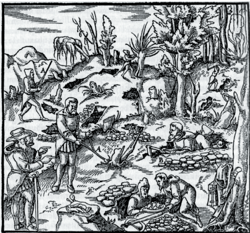
Fig. 6 – Il duplice modo di operare di coloro che ricercano minerali metallici. Il prospettore A va alla ricerca di metalli utilizzando la bacchetta da raddomante; il minatore B scava una buca da cui estrae materiale che passa a un compagno per l'esame e l'eventuale cernita (Agricola 1563, libro II fig. n.n. p. 28).
